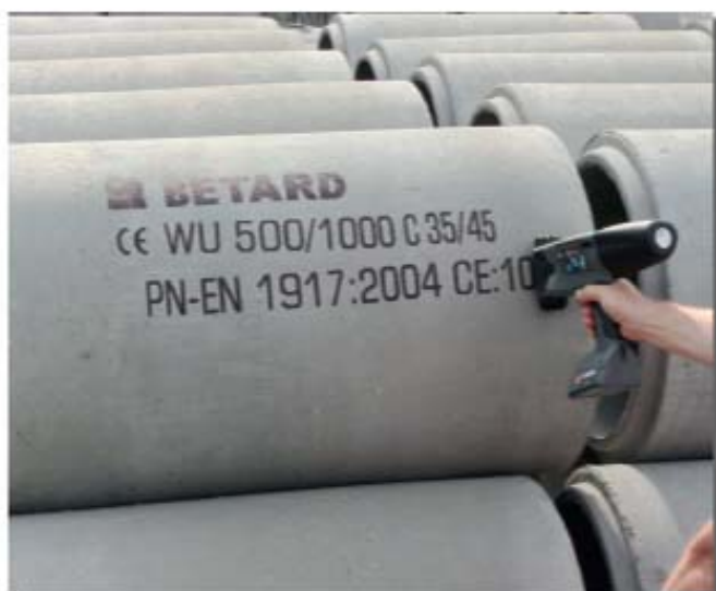
Druck auf Betonteilen mit schwarzer Spezialtinte für höhere UV Resistenz
