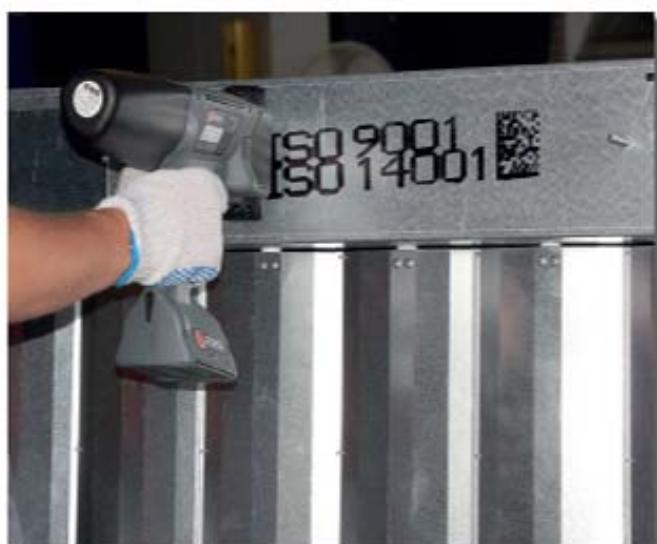
Druck auf Stahl mit schwarzer Universaltinte 2D Barcode
