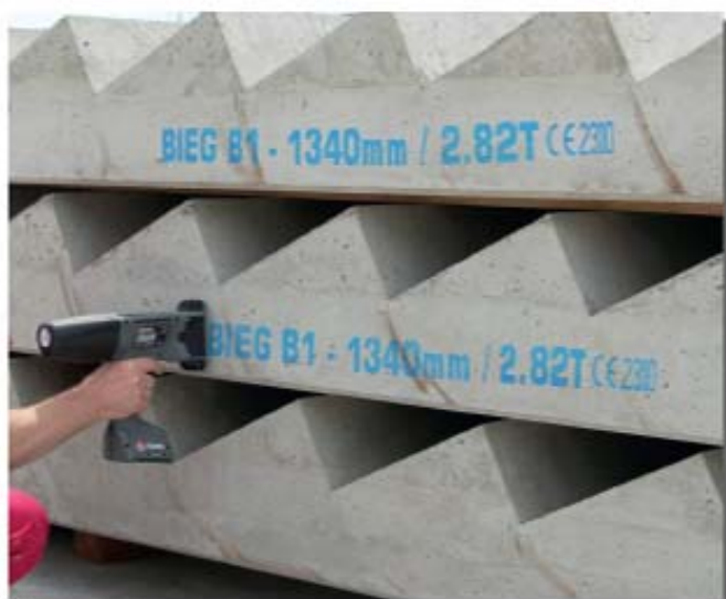
Druck auf Betonteilen mit blauer pigmentierter Tinte
