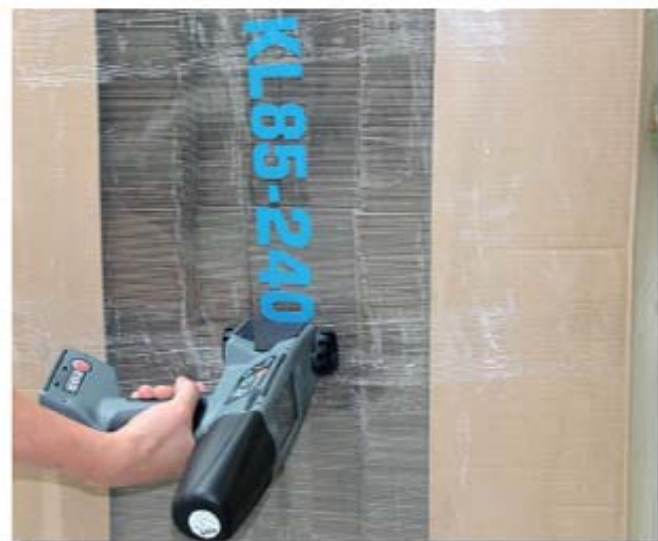
Druckt auf Stretch Folie mit pigmentierter Tinte
