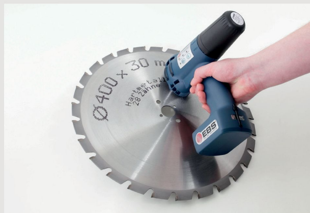
→ Druck auf Werkzeugstahl mit schwarzer Universaltinte (Ethanol); Abstandsrollen aus Metall zur besseren Haftung.
