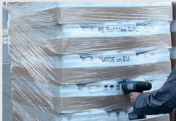
→ Druck auf Stretchfolie mit schwarzer Universaltinte (Ethanol); große Abstandsrollen.
