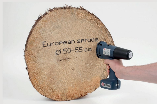
→ Druck auf geschnittenem Holz mit schwarzer Universaltinte (Ethanol); große Abstandsrollen.
